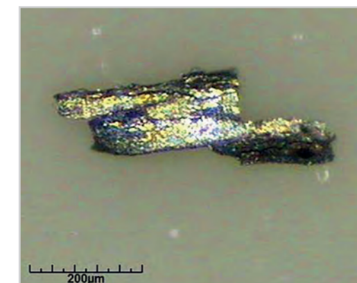
Partículas metálicas de la rosca
